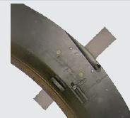
Разъемный вариант трубореза на шарнире
