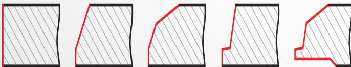
Применяя различные фасочные резцы можно получить требуемые углы фаски, в том числе сложной ломаной формы.
